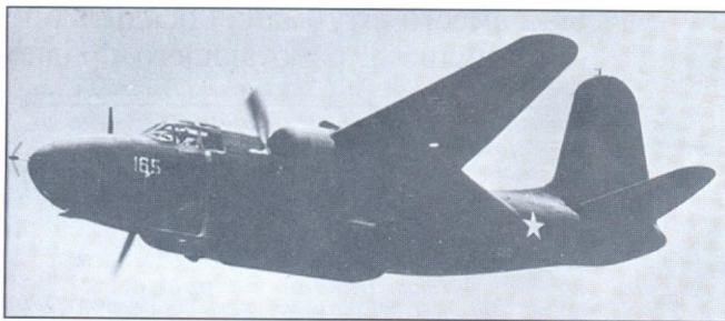
Первый американский ночной перехватчик P-70, оснащенный английским локатором с «мечевой» антенной в носу
